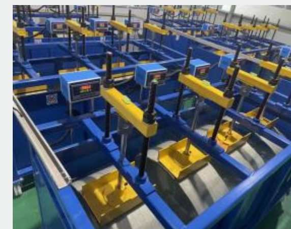
长期弯曲恒载荷试验(水浴)
