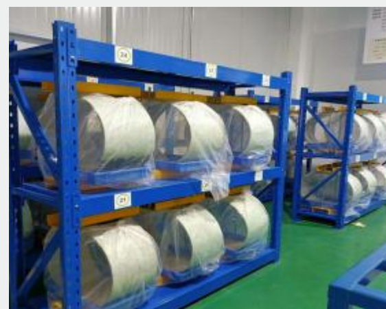
长期弯曲恒变形试验 (0.5mol H 2 SO 4 )
